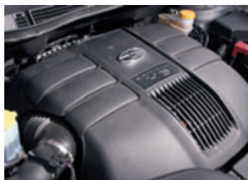
Шесть оппозитных цилиндров выдают 258 сил. Motor охотно набирает обороты и задорно звучит
