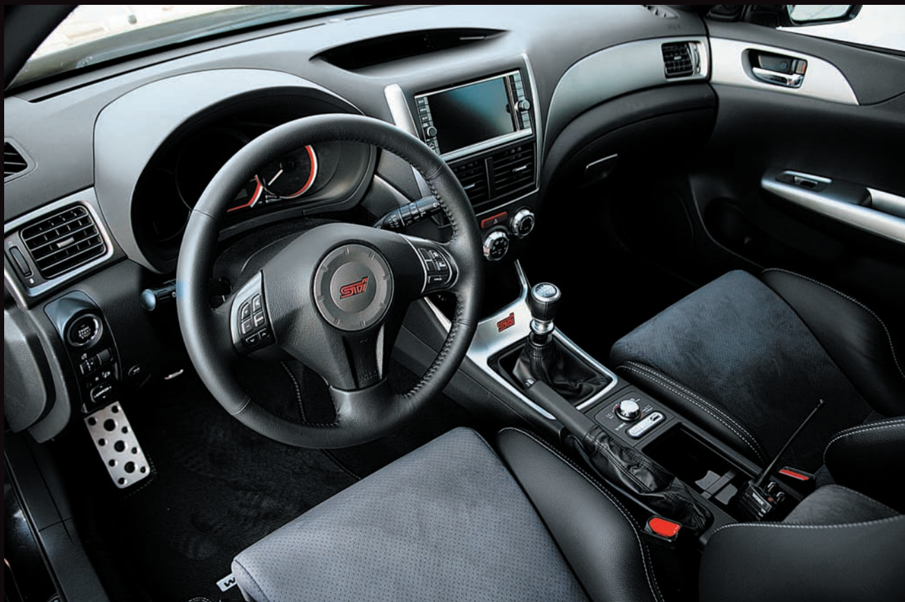
Салон новой Импрезы скроен ладно и качественно, но почти весь пластик — жесткий. Рулевая колонка теперь регулируется в двух плоскостях. Главные отличия версии STI от богато укомплектованных «атмосферных» машин — эмблема на руле и перфорированные накладки на педалях
