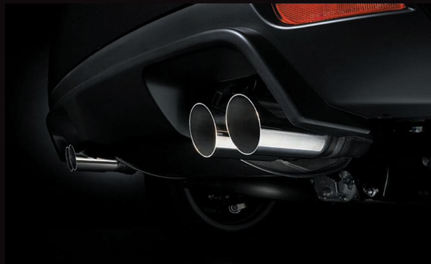
Грозный квартет выхлопных труб звучит бледновато. Поперечное расположение глушителя позволило увеличить его объем по сравнению с STI прошлого поколения
