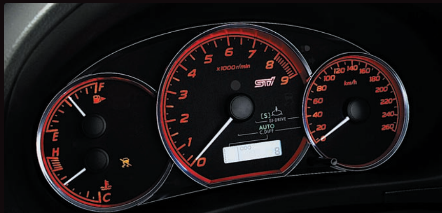
На панель приборов выводится индикация режимов системы Si-Drive и трансмиссии. В ручном режиме степень блокировки центрального дифференциала отражается в окне одометра
