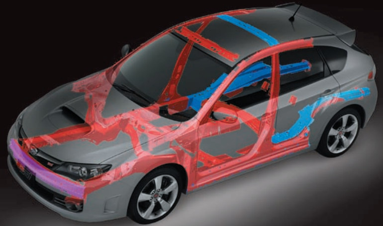
Кузов версии WRX STI жестче, чем у базового хэтчбека. Часть силовых деталей сделана из более высокопрочных марок сталей, они образуют вокруг водителя и пассажира своеобразный каркас безопасности
