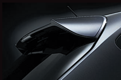
Большой задний спойлер снижает подъемную силу. По заверениям японцев, она у версии STI нулевая
