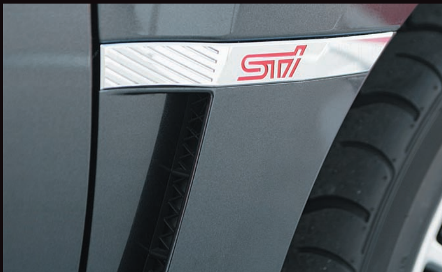
Вентиляционные отверстия в передних крыльях — не декорация. Через них отводится воздух из моторного отсека, для улучшения охлаждения турбодвигателя
