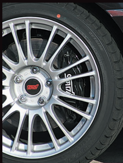
Теперь на тормоза Brembo японцы наносят собственный лейбл STI. Тормозные диски стали чуть больше, увеличен диаметр поршней в задних суппортах
