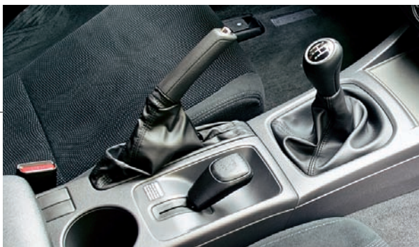
Рядом с ручником – рычажок включения пониженной передачи.
